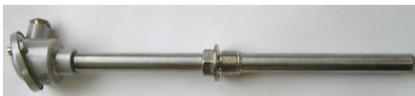
Рисунок 5 – Корпусной термопреобразователь с алюминиевой головкой
